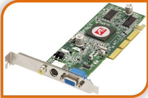
Una **tarjeta gráfica, tarjeta de vídeo, tarjeta aceleradora de gráficos o adaptador de pantalla**, es una tarjeta de expansión para una computadora personal, encargada de procesar los datos provenientes de la CPU y transformarlos en información comprensible y representable en un dispositivo de salida, como un monitor o televisor.
